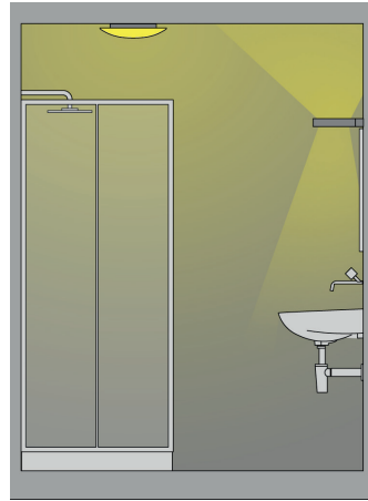
Luminaire / emplacement approprié
